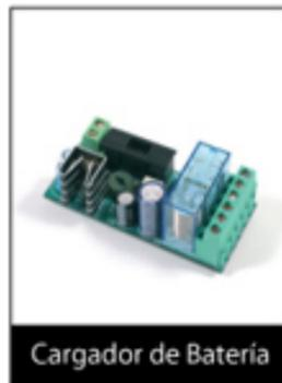
Tarjeta que se inserta al panel principal de la barrera, proporciona respaldo de pila operacional. Requiere pilas 12 VDC no incluidas.
